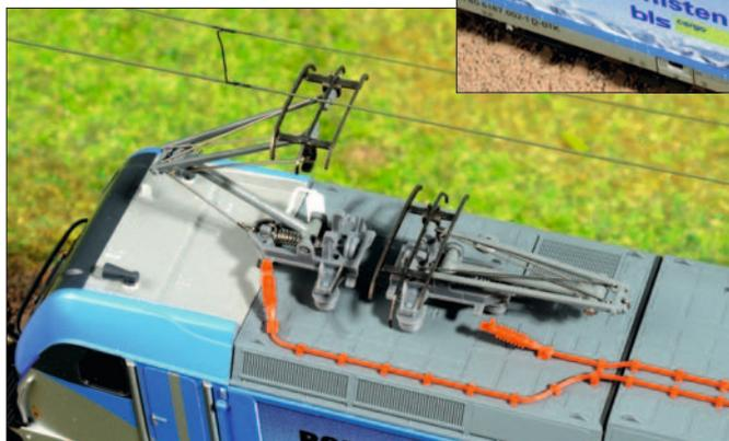
Auch angehoben kann der Pantograph überzeugen. Hinter dem angehobenen Panto ist der Überspannungsableiter zu erkennen, hinter dem abgesenkten gerade noch der silberne Auspuff.
